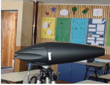
Figura 16. Determinación de características acústicas de sala 5, colegio Francisco Valdés Subercaseaux. Curarrehue, Región de la Araucanía.
