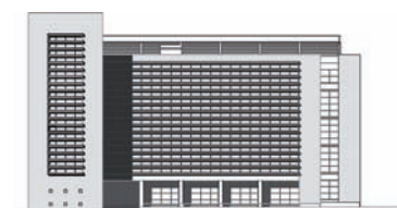
Fachada nor-orienté: Losetas de hormigón como aleros
