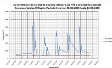
Figura 22. Evolución concentración de CO 2 en aire interior y exterior. Aula 5 Escuela Francisco Valdés Subercaseaux periodo 0.8.08. 2010 hasta 24.08.2010.
